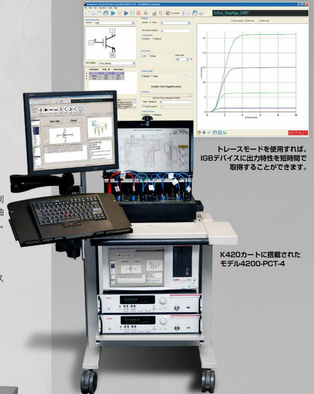
トレースモードを使用すれば、IGBTデバイスに出力特性を短時間で取得することができます。
