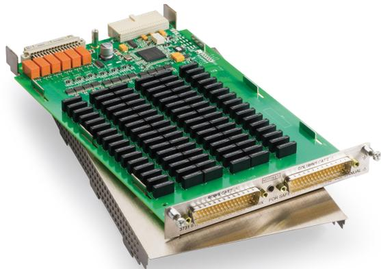
3731 型は 2 極、6 行 16 列のリード・リレー・マトリクス・カードです。作動時間が 0.5ms の高速リード・リレーを使用することで、スループットが要求されるアプリケーションの要件を満たすと同時に、10 億回以上の作動が可能な長寿命により、ユーザに高い付加価値をもたらします。カードは最大 6 つの差動チャンネルを 16 台の DUT (被測定デバイス) に任意の組み合わせで接続することができます。アナログ・バックプレーン接続リレーを使用することで、任意の列を 3700A シリーズ・メインフレームのバックプレーンに接続することができます。そのため、マトリクスの列を簡単に拡張することができます。1 台の 3706A 型メインフレームで最大 6 行 96 列のマトリクスをサポートできます (3731 型カードを 6 枚使用)。
