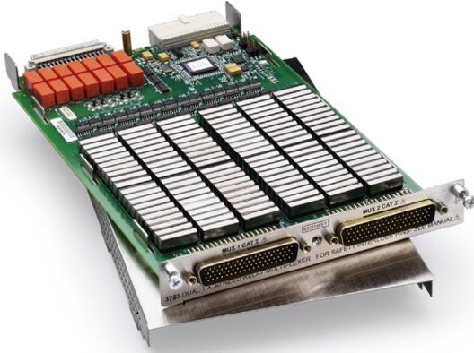
3723 型は、2つの独立したバンクを備えた高速 1 × 30 の 2 極マルチプレクサで、高速スキャン・アプリケーションに最適です。2つのバンクは、アナログ・バックプレーン接続リレーを介して、3700A シリーズ・メインフレームのバックプレーンやオプションの DMM に自動的に接続できます。この接続により、メインフレームは 3723 型を 1 つの 1 × 60 の 2 極マルチプレクサ、または 1 つの 1 × 120 の単極マルチプレクサに再構成できます。また、カード間拡張により、さらに大規模な構成にも対応できます。
